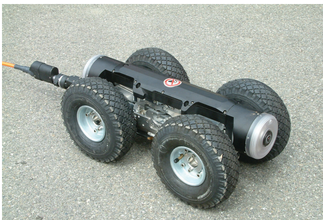
Das PANORAMO Kamera System kurz vor dem Einsatz im Kanal.
