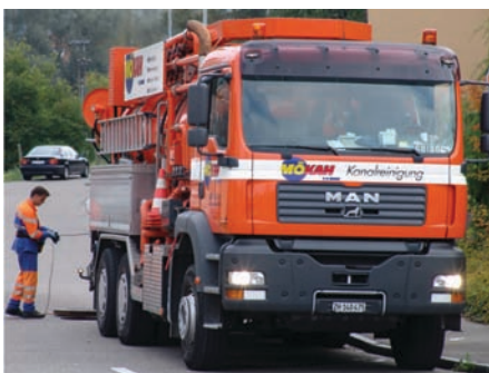
Kanalreinigungsfahrzeug von MÖKAH im Einsatz.
