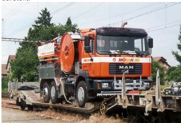
Der RAIL-Jet ist ein speziell für Eisenbahnbetreiber optimiertes Kanalreinigungsfahrzeug.
