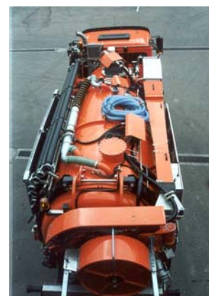
Alle wasserführenden Schlauchleitungen auf dem Fassschiebel sind verkleidet.
