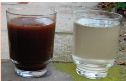
Links Waschwasser— rechts gereinigtes Wasser bereit zur Einleitung in die Kanalisation
