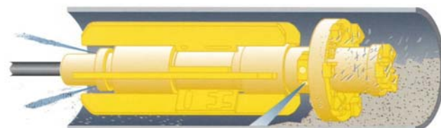
Mit bis zu 8 Tonnen Schlagkraft und 600 bis 3000 Schlägen pro Minute können auch härteste Ablagerungen entfernt werden
