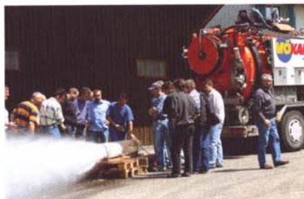
Vorführung einer Reinigungsdüse in Plexiglasrohr
